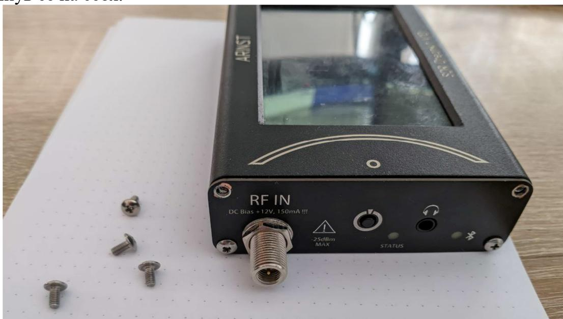
Открутите 2 винта крепления экрана и держа плату экрана со стороны паяных контактов (противоположной круглым крепежным отверстиям), покачивая потяните на себя и отсоедините.
