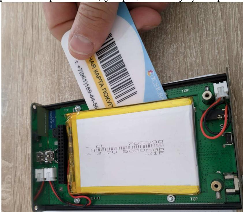
Отсоедините разъем питания, потянув его из ответной части разъема на плате.
