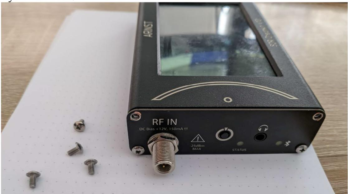
Открутите 2 винта крепления экрана и держа плату экрана со стороны паяных контактов (противоположной круглым крепежным отверстиям), покачивая потяните на себя и отсоедините.
